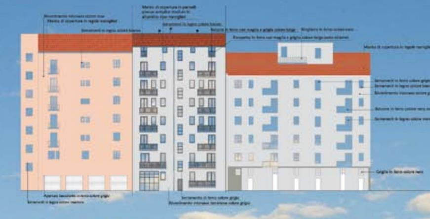
PROSPETTO CORTILE INTERNO STATO AUTORIZZATO (EX STATO IN PROGETTO)
